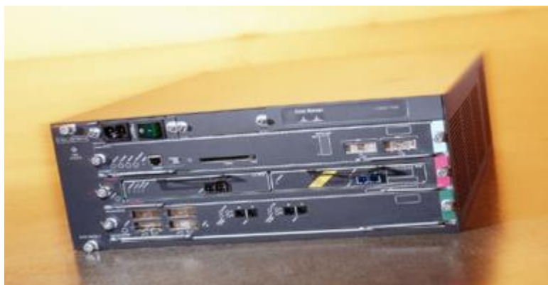
Сурет 2.3 - "Cisco 7603 OSR" маршрутизаторы
